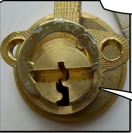
REINSTALL THE CIRCLIP AND YOU ARE COMPLETE!
