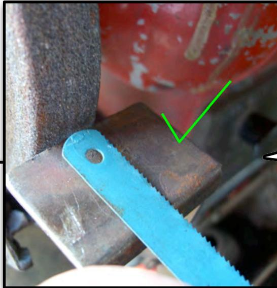
NEVER USE THE SIDE OF THE GRINDING WHEEL. ALWAYS USE THE FRONT EDGE!
