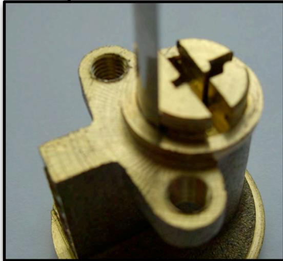
INSERT A BLANK KEY INTO THE LOCK, THEN BEGIN TO SLIDE THE SHIM IN FROM THE BACK. AS THE SHIM CONTACTS THE FIRST KEY PIN, SLOWLY REMOVE THE KEY BLANK ONE PIN POSITION ALLOWING THE KEY PIN TO SLIDE DOWN AND THE SHIM TO ENTER THE SPACE BETWEEN THE KEY AND DRIVER PIN. REPEAT THE PROCESS FOR EACH PIN POSITION, MOVING THE SHIM FARTHER INTO THE LOCK EACH TIME
